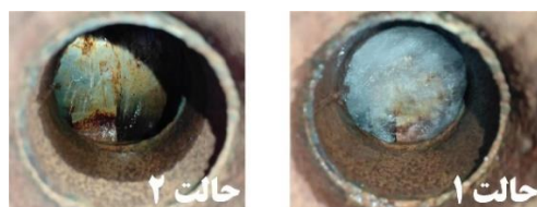
شکل (۱۰): تصویر فضای داخلی محفظه شیر در گشودگی ۸۰ درصد در حالت (۱) طرح اصلی و حالت (۲) همراه با دو برگرداننده
