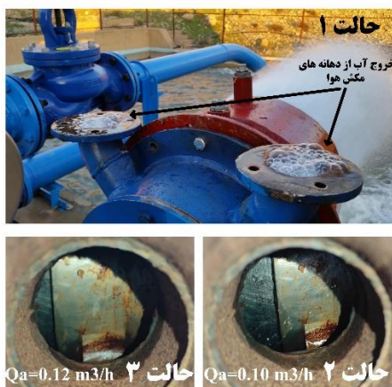
شکل (۹): مشاهدات عینی تفاوت جریان برگشتی در گشودگی ۴۰ درصد برای سه حالت (۱) طرح اصلی، (۲) بکارگیری یک ردیف حلقه برگرداننده و (۳) بکارگیری دو ردیف حلقه برگرداننده
